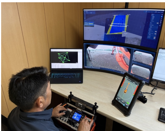
遠隔操作室（左）と油圧ショベル ZX200A-7（右）
