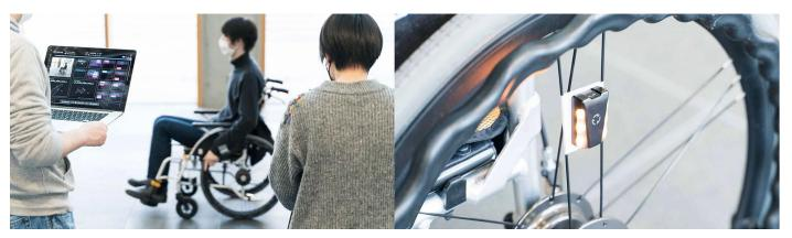
車椅子利用者に使い方を指導する場で、エビデンスに基づいてその人にあった漕ぎ方を理解するため、車椅子にセンサーデバイスを取り付けてデータを収集・解析しています。
