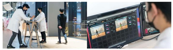
美容のための歩行カウンセリングイベントにおいて、歩行者自身による解析結果の確認を実現しています。 撮影した歩行者の映像をアプトポッドが提供する高速 IoT プラットフォーム『intdash』に収集し、骨格検出・歩容 解析した結果をリアルタイムに解析結果ビューアー『ORPHE ANALYTICS Viewer』で表示します。 精微な足元の動きや姿勢などを数値として確認でき、改善前後でどう歩きが変化したのかを理解するのに寄与してい
